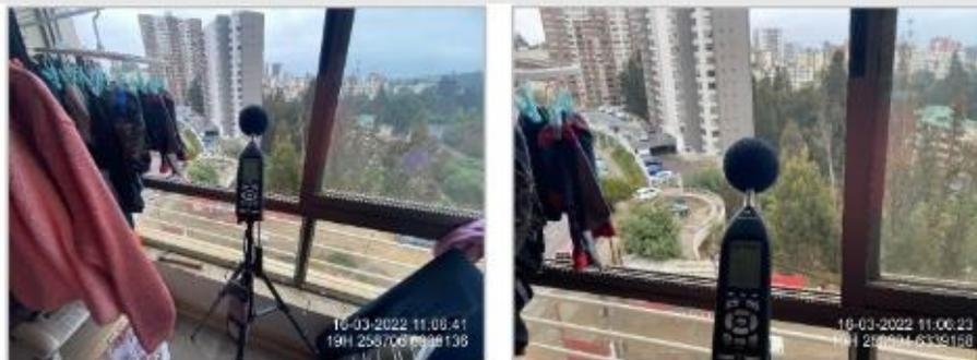
A continuación, se presentan fotografías de las mediciones al interior de todos los puntos receptores. Se recalca que las mediciones se realizaron conforme al procedimiento descrito en el D.S. N°38/11 del MMA que señala que se deben realizar tres puntos de medición separados entre sí en aproximadamente 0,5 metros, entre 1,2 y 1,5 metros sobre el nivel del piso y, en caso de ser posible a 1,0 metros o más de las paredes, y aproximadamente a 1,5 metros de las ventanas, vanos o puertas.
