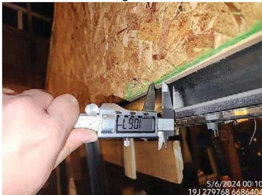
**Descripción medio de prueba:** Espesor de paneles OSB de sobre tabique de fachada este.
