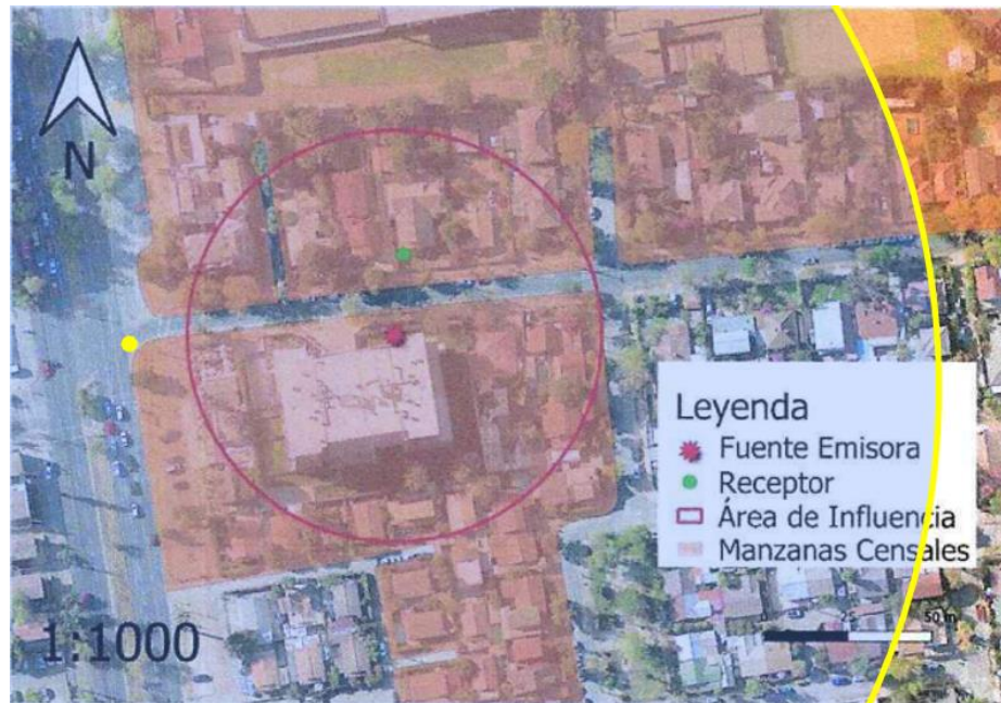
Superposición entre el área de percepción de ruido de fondo de por lo menos 80 dB proveniente de la calle Avenida Ossa ( en color azul y origen en punto amarillo) y la medición efectuada por la SMA (punto y área en color rojo).
