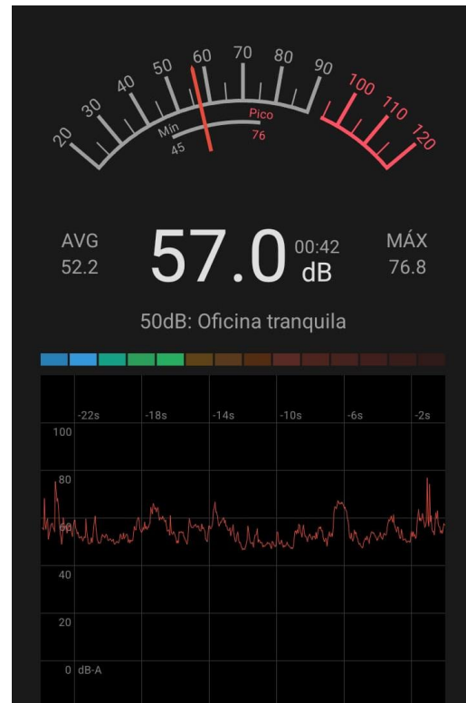
Nivel de presión sonora en exterior a 7 metros de la fachada sistema encendido.
