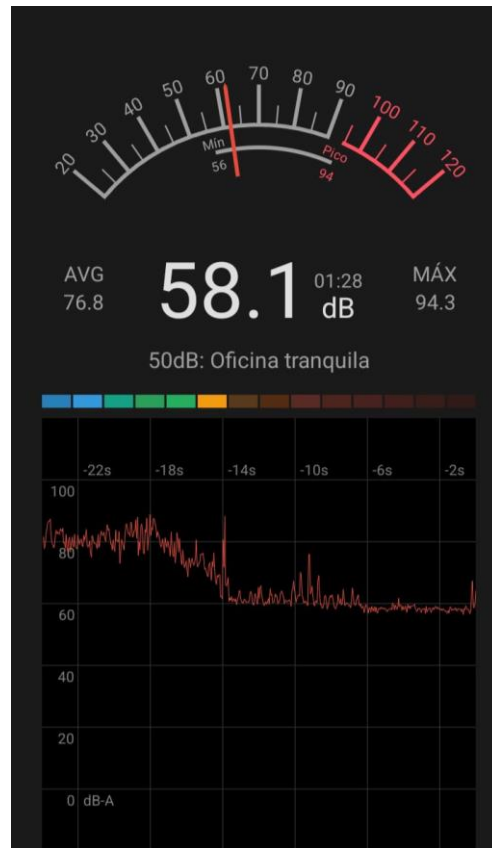
Nivel de presión sonora en exterior a 7 metros de la fachada sistema apagado.
