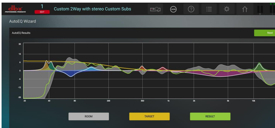
Curva de ecualización aplicada a sistema solo con parlantes activos encendidos.
