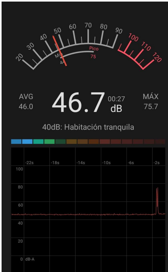
Nivel de presión sonora al interior del local con sistema activo apagado.
