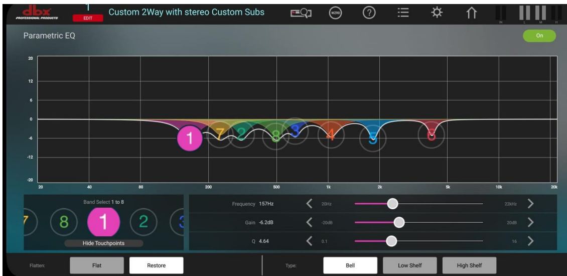
Curva de equalización de corrección aplicada a parlantes pasivos.
