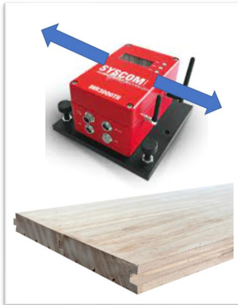
Imagen 13. Efecto dinámico de oscilación lateral (cabeceo del instrumento) debido a la flexibilidad y ligero de la terminación de piso de madera. Fuente: Elaboración propia.
