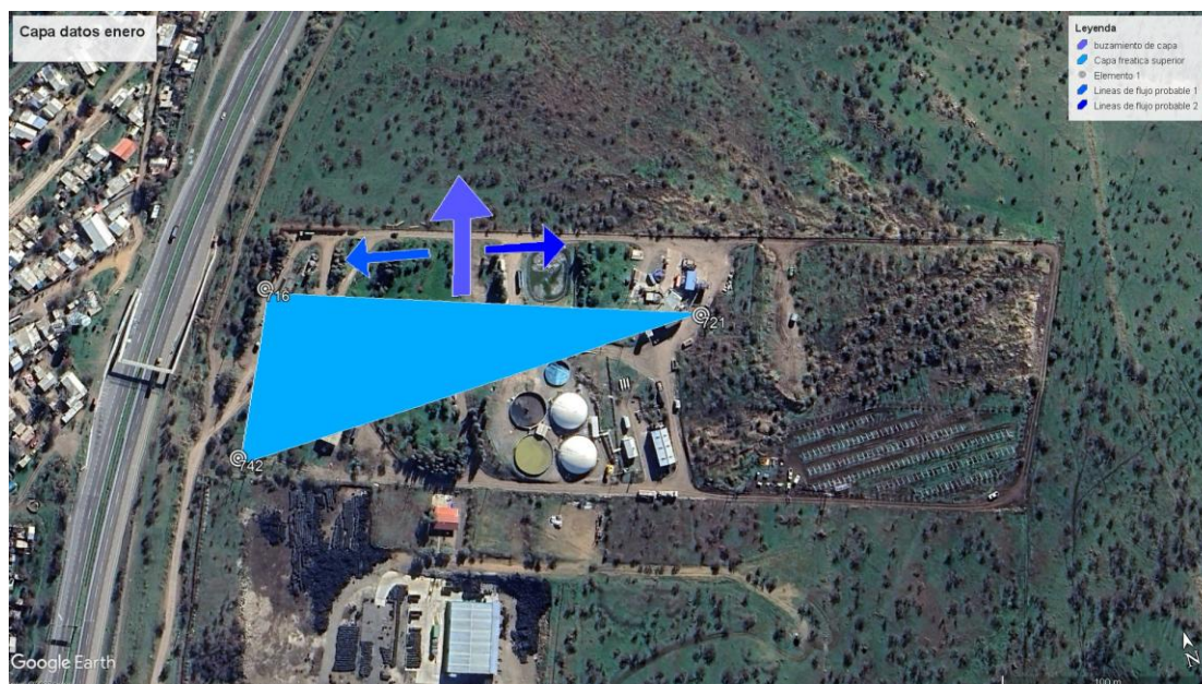
Figura 8 modelo de la capa piezométrico por método de 3 puntos con datos de enero 2025.
