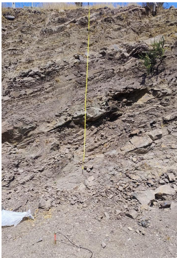
Figura 10 estructura estratigráfica encontrada bajo la planta, un flanco del pliegue.
