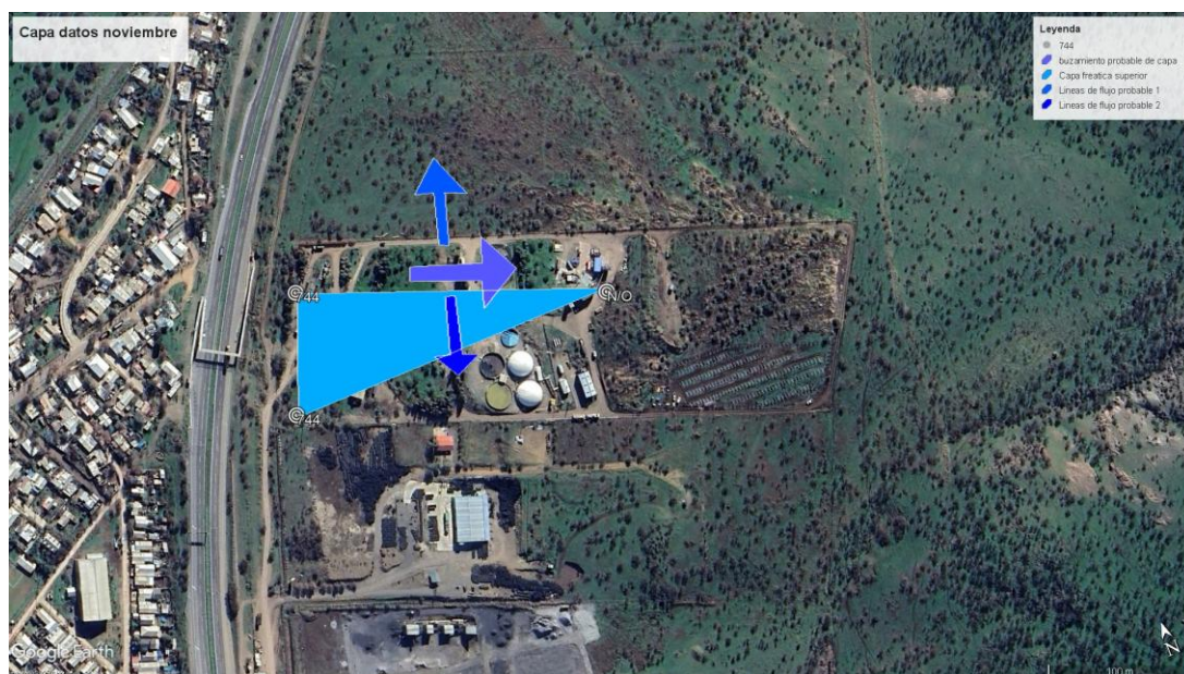
Figura 9 modelo de la capa piezométrico por método de 3 puntos con datos de noviembre 2025.
