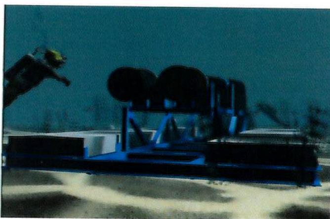
Figura 3: Detalle del proyecto "SIAM", referido a las bombas proyectadas a instalar en el fondo marino
