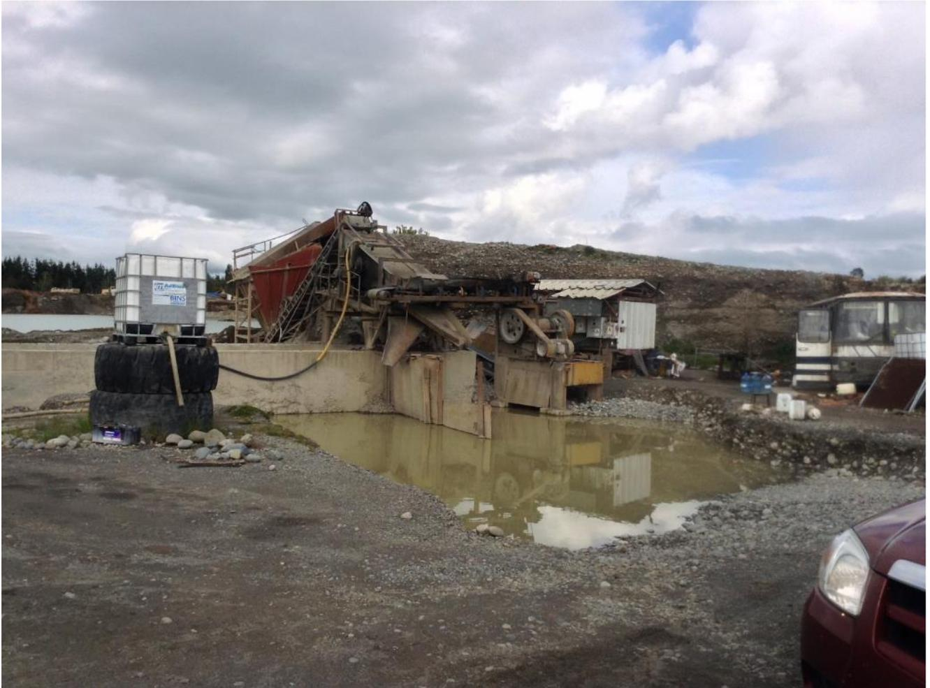
Fotografía N° 4: Se observa el sector antiguo para procesar el material, incluye planta chancadora y correa transportadora.
