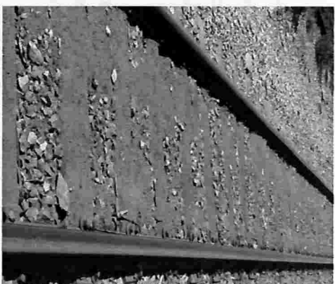
Fotografía N° 5 (izquierda): Nivel de mineral en vagón con cúpula posterior al paso por el entrasador (16.03.2017)
