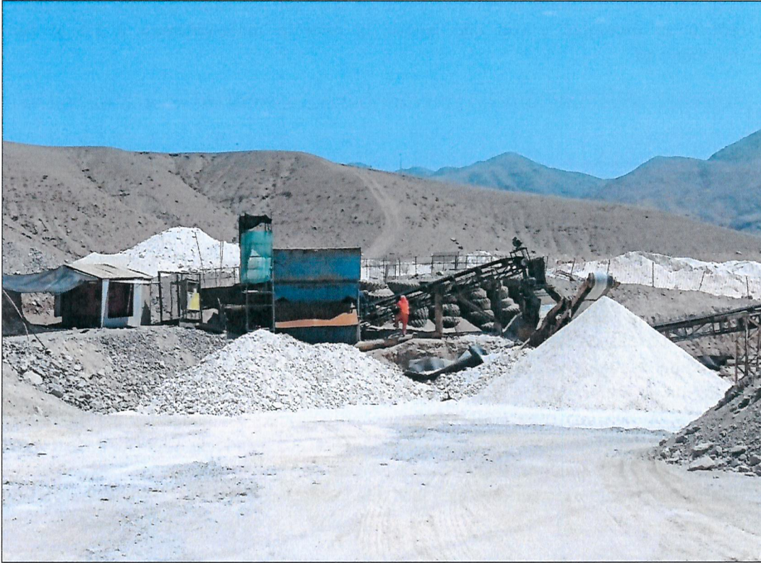
Figura 11. Área de procesamiento. El harneado selecciona las sales de acuerdo a su diámetro, separando a aquellas menores a 3 mm (acopio derecho) de las de mayor diámetro (acopio izquierdo). Éstas últimas constituyen el rechazo, el cual es dispuesto en una cancha para luego ser distribuida en caminos al interior de las instalaciones.
