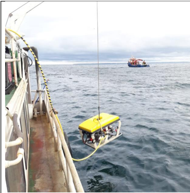
Imagen N°1: Equipo ROV sumergible, para visualización del módulo de cultivo siniestrado del CES Caicura.
