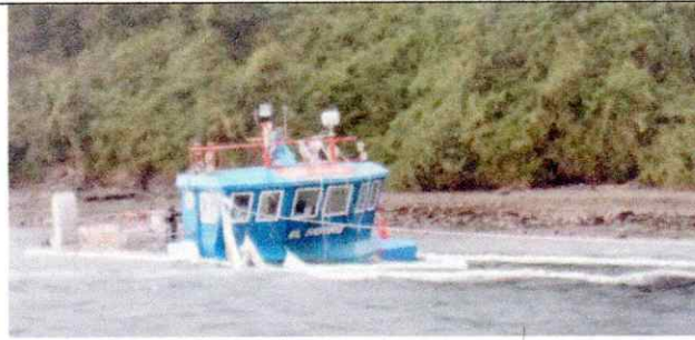
Imagen N°3: Pontón hundido, se aprecia boa blanca para confinamiento del derrame.
