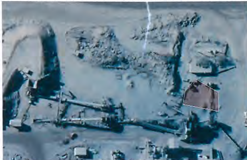
Figura 5: Localización y superficie de las pilas de polvo mineral a un costado del Chancador 3°
