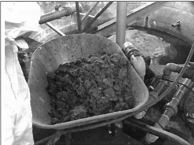
Fotografía N°1: Carretilla de acumulación de residuos sólidos, ubicada debajo del tamiz de filtrado, y que luego es llevada a sala de residuos.
