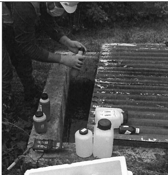
Fotografía N°7: Toma de muestra puntual del ril efluente antes de ser infiltrado.
