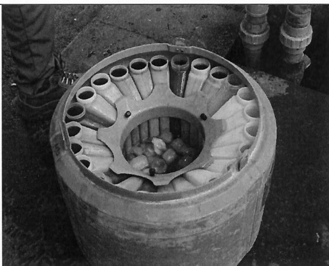
Fotografía N°6: Muestras puntuales de 1 litro tomadas cada 15 minutos para preparación de muestra compuesta del ril afluente.
