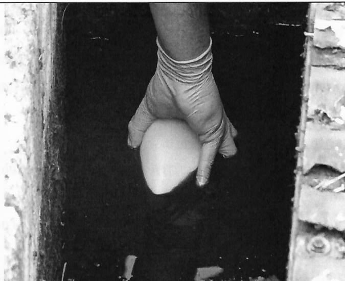
Fotografía N°8: Toma de muestra puntual del ril efluente, el cual se observa de color oscuro.
