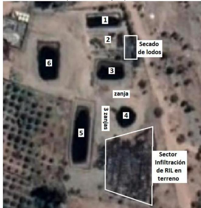
Fuente: Google Earth 2021, fechas de imágenes: 10/06/2020. En numerales 1 a 6 se observan las piscinas; 3 zanjas de infiltración y sector infiltración de RIL en terreno
