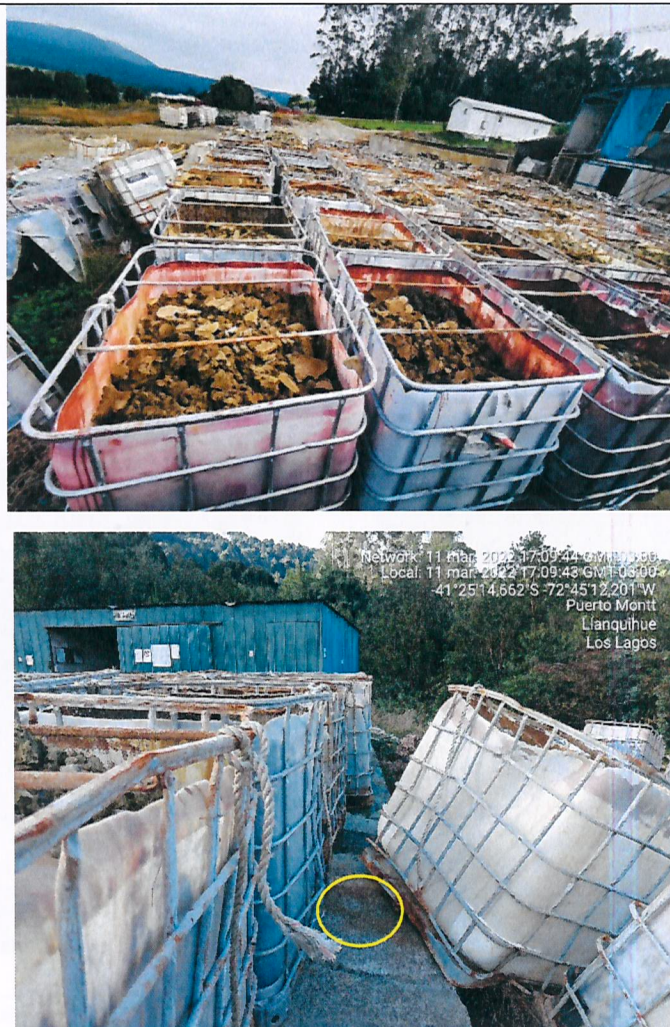
Fotografía N°13: Imagen permite observar bins IBC de 1000 litros los cuales son envases de pintura antifouling que son reutilizados para acopiar lodo prensado los cuales se encuentran a la intemperie, demarcación amarilla resalta lixiviación de los contenedores.
