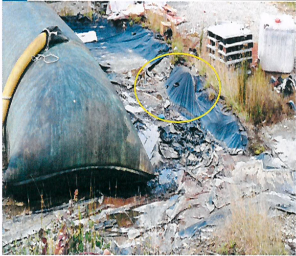
Fotografía N°27: Se destaca en círculo amarillo rotura de la membrana impermeable.
