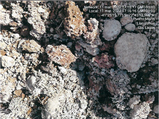
Fotografía N°37: Imagen permite constatar que en la zona de infiltración se ha dispuesto lodo prensado y que ha sido mezclado con material tipo ripio.
