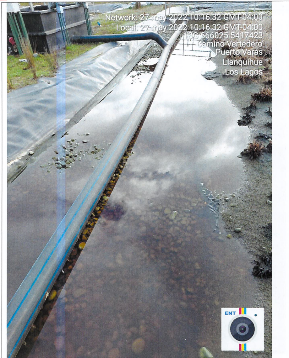
Fotografía N°2: área del wetland, donde se observa el líquido tratado que llega, el cual el día de la inspección es de color café cobrizo.
