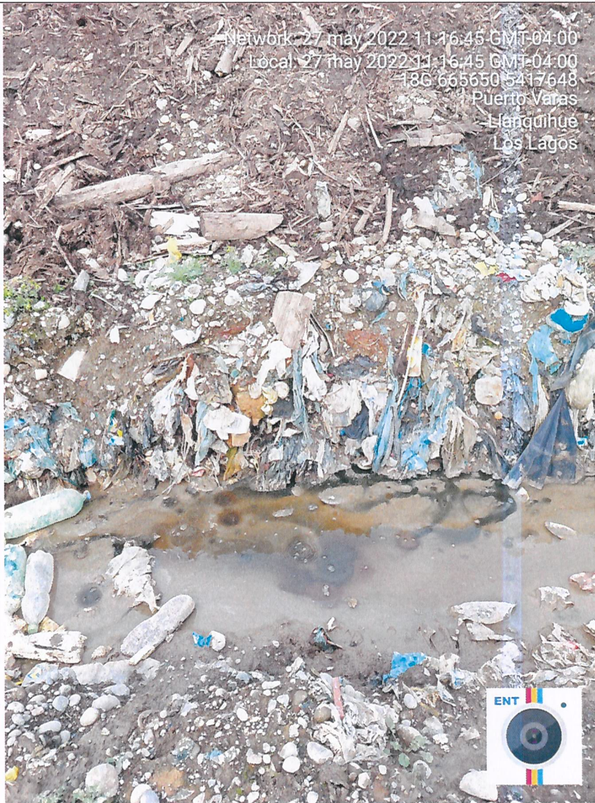
Fotografía N°9: cuneta del lado norte del alveolo 1 se constata agua lluvia mezclado con lixiviados y residuos.
