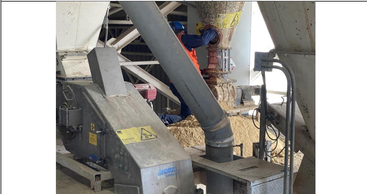
Fotografía N° 6 Fecha: 7-07-2022 Coordenadas UTM DATUM WGS84 HUSO 19 Norte: 6305529 Este: 285726 Descripción del medio de prueba: Operario extrayendo material particulado desde los ciclones.
