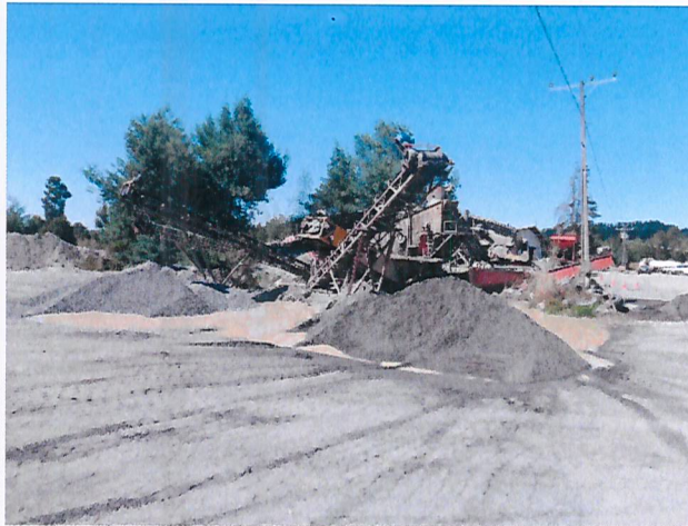
Imagen N°2: Maquina procesadora y seleccionadora de áridos, la que usa aguas del estero Traiguén, tanto para el procesamiento como para el lavado de los áridos, generando los riles de la planta.
