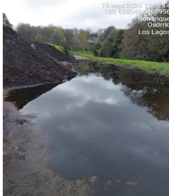
Imagen 8. Empozamiento lixiviado bajo una pila de compost de 1000 m 3 aprox. con un gramaje de 20 mm.
