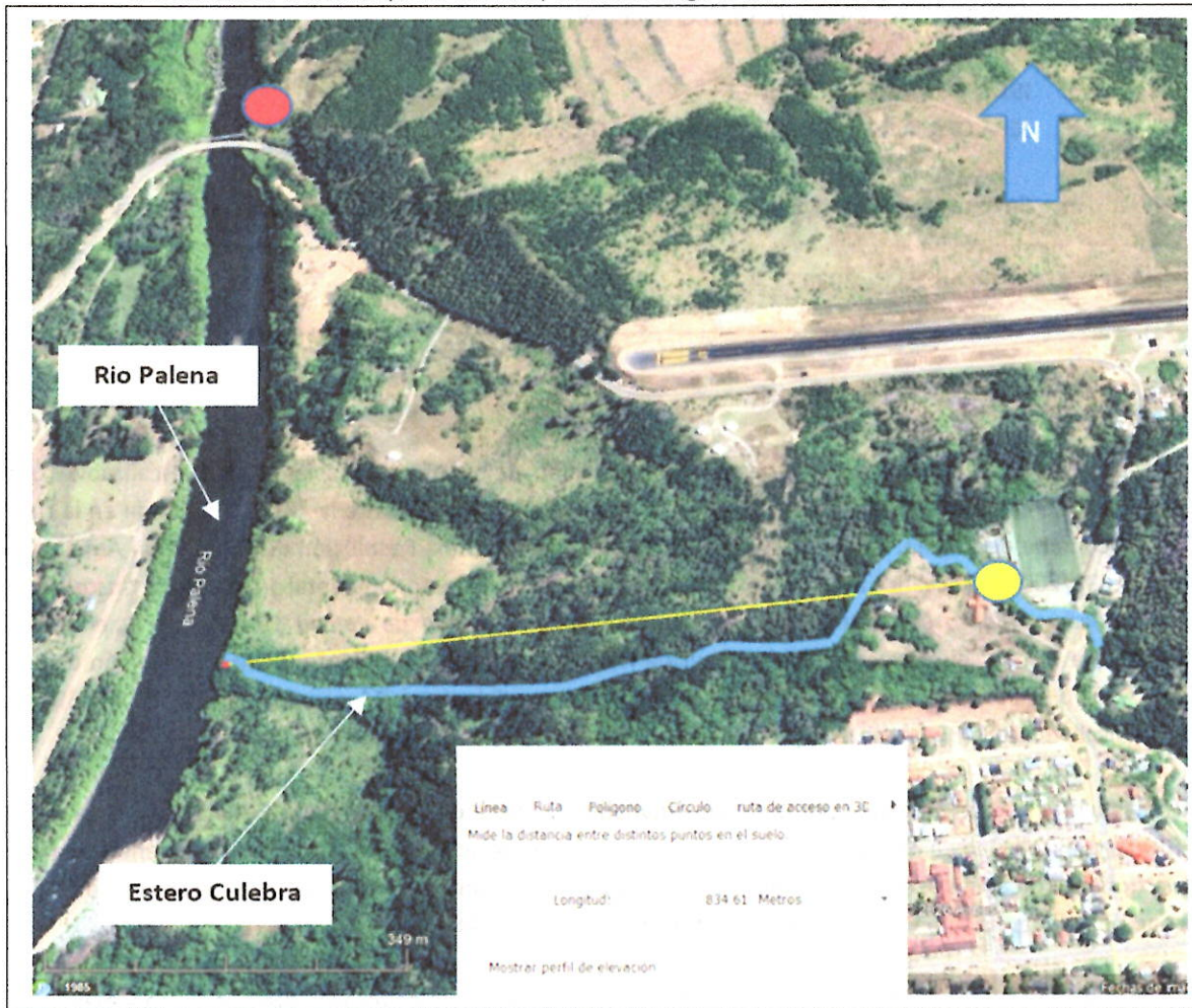
Imagen N°1. Mapa de descarga actual de la UF (punto amarillo) y de lo proyectado en RCA (punto rojo), detallando la distancia (línea amarilla) de la descarga al río Palena, de cerca de 834 m.
