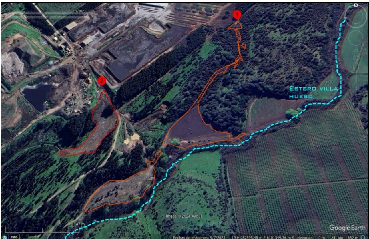
Figura 3. Imagen satelital Google Earth del año 2023 donde se aprecian escurrimientos de lodos (en rojo se indica origen principal) - Informe (DFZ-2024-2225-VII-RCA)
