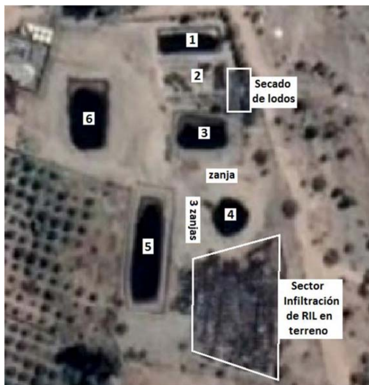
Imagen N°2 "Distribución piscinas, zanjas y sector infiltración en terreno"
