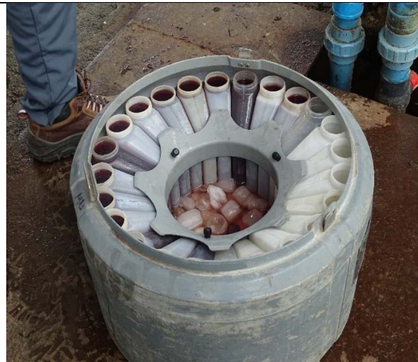
Fotografía N°6: Muestras puntuales de 1 litro tomadas cada 15 minutos para preparación de muestra compuesta del RIL afluente.
