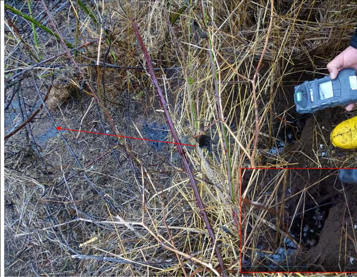
**Fotografía N°6:** Se observa zona de afloramiento de lixiviados que van a dar a la quebrada del estero sin nombre. En imagen ampliada se observa punto de inicio de afloramiento de lixiviados, y afloramiento de burbujas.
