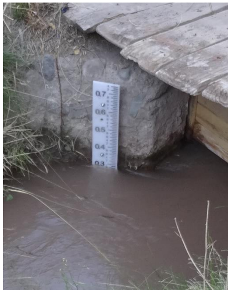
Fotografía 2: regla para medición del caudal, que marcaba 0,28 en Canal El Manzano
