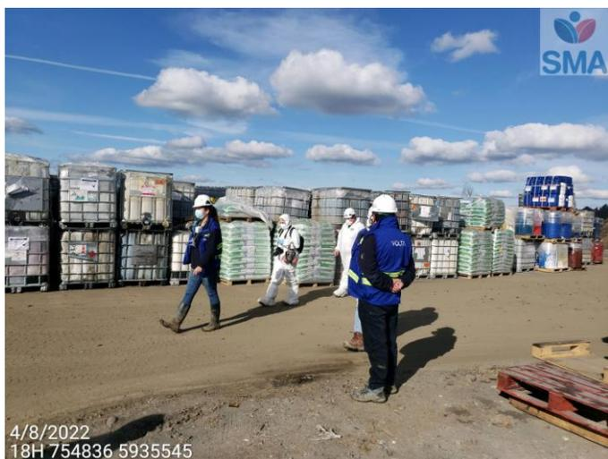
Foto 4 Estación 1 CITA Acopio Respel intemperie, sin pretil de seguridad ni impermeabilización basal.
