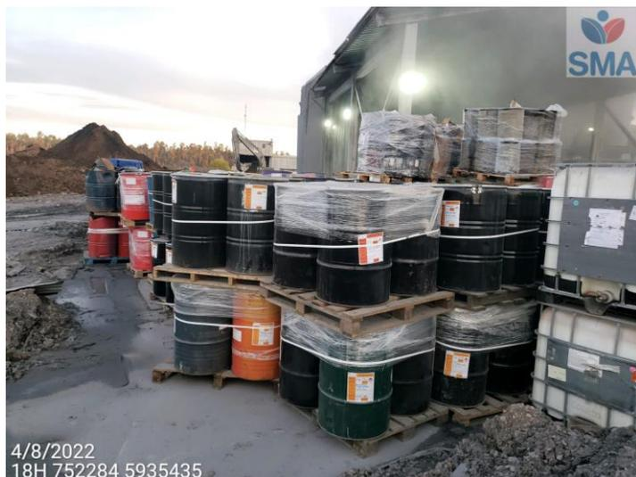
Foto 6 Estación 1 CITA Acopio RESPEL intemperie, sin pretil de seguridad evidencia derrame en zona base inferior.
