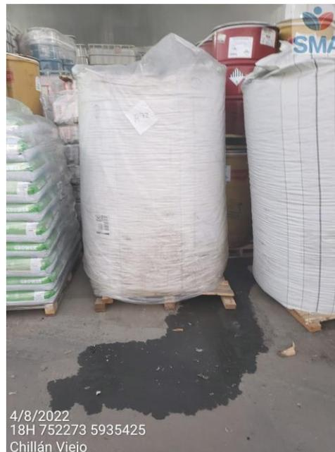
Foto 7 Estación 1 CITA Acopio Respel con restos de hidrocarburos a la intemperie, sin pretil de seguridad ni impermeabilización basal, evidencia aguas lluvias de contacto en base inferior.
