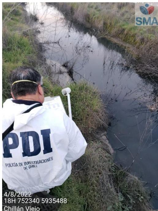
Foto 15 Estación 1 CITA Zanja de aguas lluvias muestra de fondo con hidrocarburos y valores de conductividad elevados.
