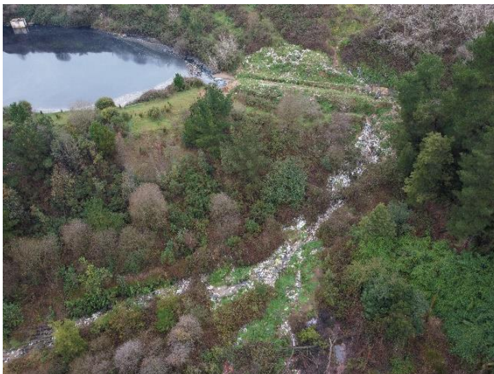
Imagen N°3: Sector de escurrimiento de los lixiviados desde la laguna hacia el estero El Mosco
