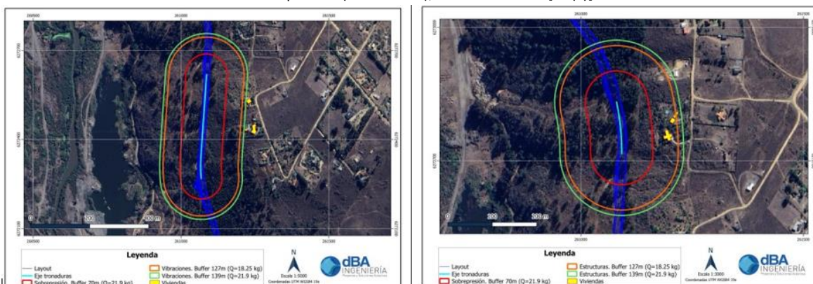
Figura N°9: Estimación del Buffer de cumplimiento 5 [mm/s] para vibraciones y 133 [dB] para sobrepresión sobre estructuras según cargas consideradas, en el subsector de San Juan, que estarían en el límite de sufrir daño por impacto de sobrepresión (onda aérea), AS 2187.2:2006 [dB(L)].
