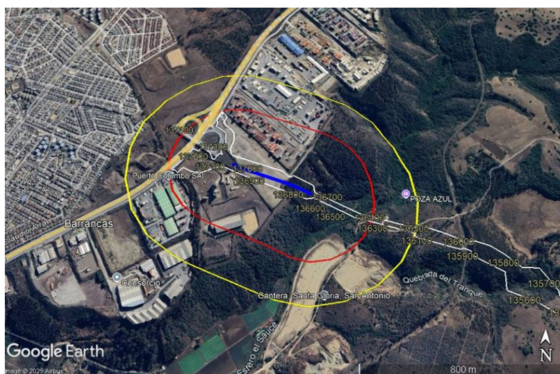
Figura 7: Representación gráfica de las zonas o áreas tronables en el subsector “5.4.” de la Variante San Juan, en la comuna de San Antonio, observada de color azul, junto con las zonas de exclusión en donde se observa en color rojo la zona de exclusión de 300 metros y en color amarillo la de 500 metros.
