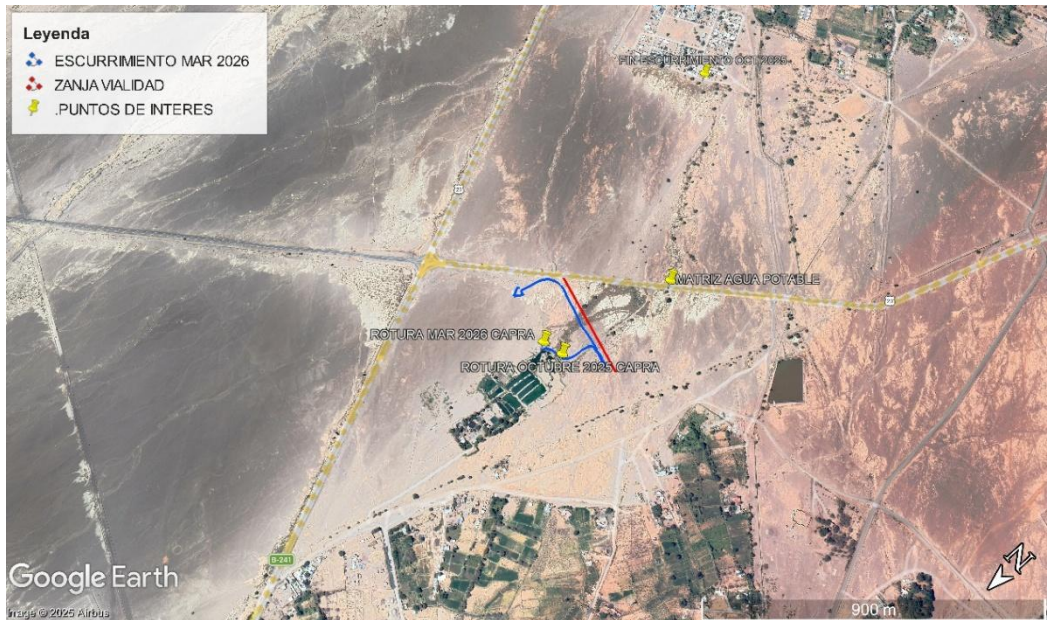
Figura N° 4. Ubicación referencial -en azul- del escurrimiento de las aguas vertidas producto de la contingencia ocurrida el 09 de marzo de 2026 desde talud de contención de piscina de rebalse y -en rojo- de del pretil de contención construido por Vialidad. Con marcadores amarillos se muestra de arriba abajo: i. fin escurrimiento incidente 2025; ii. Punto de intersección con matriz agua potable en oct 2025; iii. Rotura pretil marzo 2026 y iv. Rotura pretil octubre 2025.
