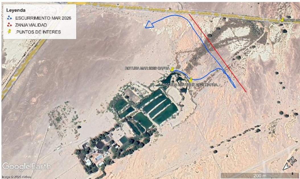
Figura N° 5. Acercamiento de la Imagen N°1, con foco en los puntos de rotura de pretil 2025 y 2026. En azul, se muestra el escurrimiento ocurrido con fecha 09 de marzo de 2026, mientras que en el color rojo se observa el pretil construido por Vialidad.
