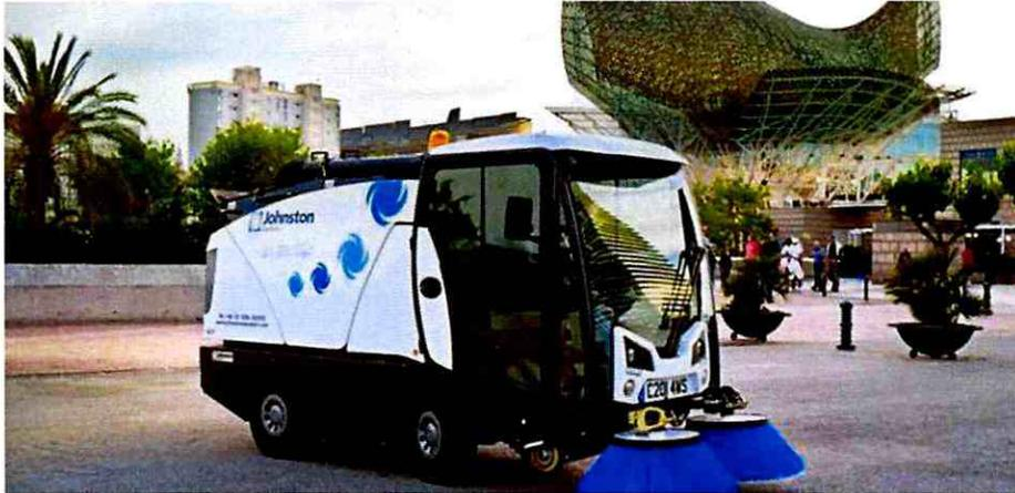
Equipo Compacto de Barrido Dual en Húmedo, con toberas independientes de aspiración, año 2018, de 2M3 de capacidad de tolva, construido en Inglaterra, que se utilizará para el barrido de todas las calles.
