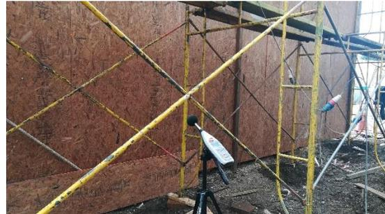
**Figura 6.** Medición realizada con fuente de ruido al interior del túnel acústico.
