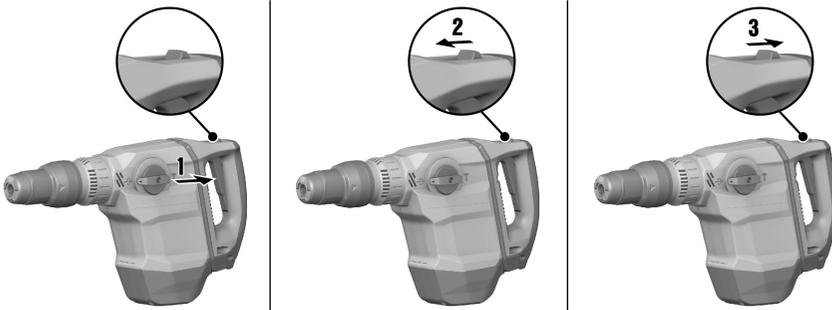
1. Deslice hacia delante el botón de fijación para marcha continua.
