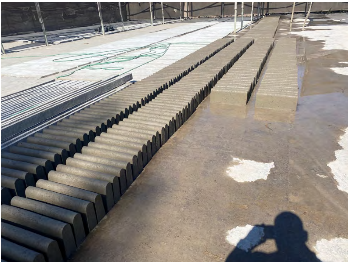
Elementos ya vaciados en cancha de secado.
