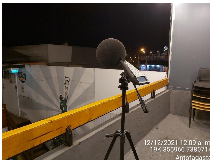
Figura 4. Condiciones de medición de ruido de fondo en el punto 2.
