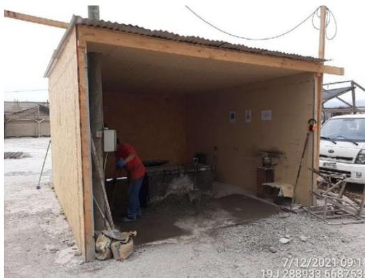
**Mesa vibradora de hormigón**
