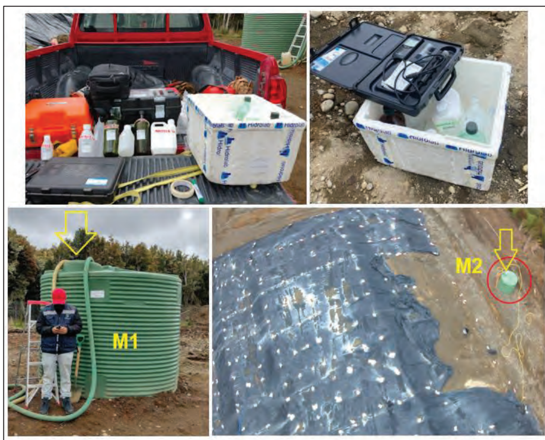
Figura 14. Evidencia gráfica de la toma de muestras M1 y M2 lixiviados RS Puntra.
