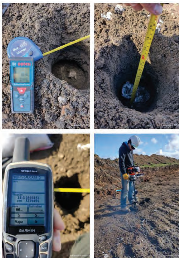
Figura 6. Registro fotográfico de calicatas no invasivas sobre el relleno sanitario.
