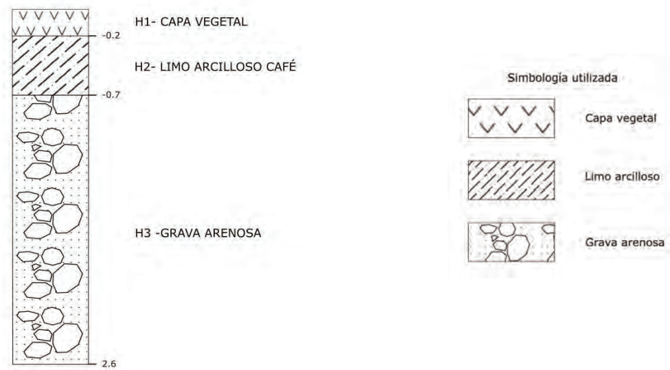
Figura 3. Columna estratigráfica N°1
