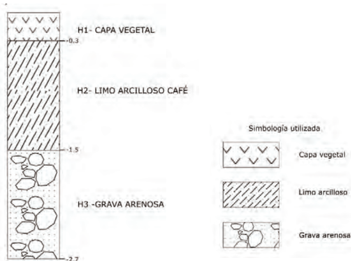
Figura 4. Columna estratigráfica N°2
