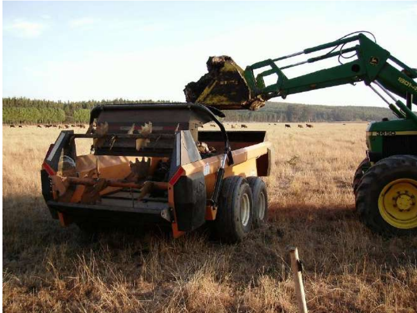
Figura nº17. Foto del tractor con estercolera utilizado en el servicio de incorporación
