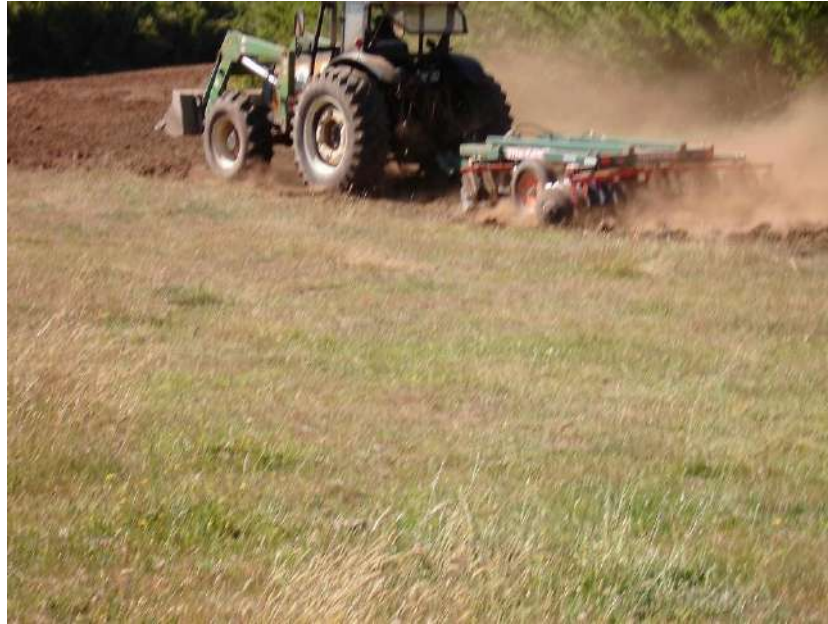
Figura nº19. Fotografía de la incorporación del lodo al suelo por medio de la rastra de disco.
