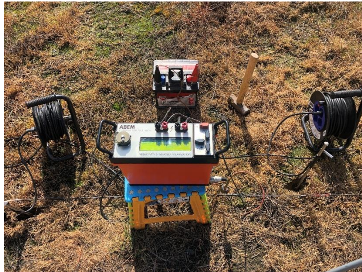
Figura #7. Equipo utilizado, ABEM Terrameter SAS1000, origen Sueco.
