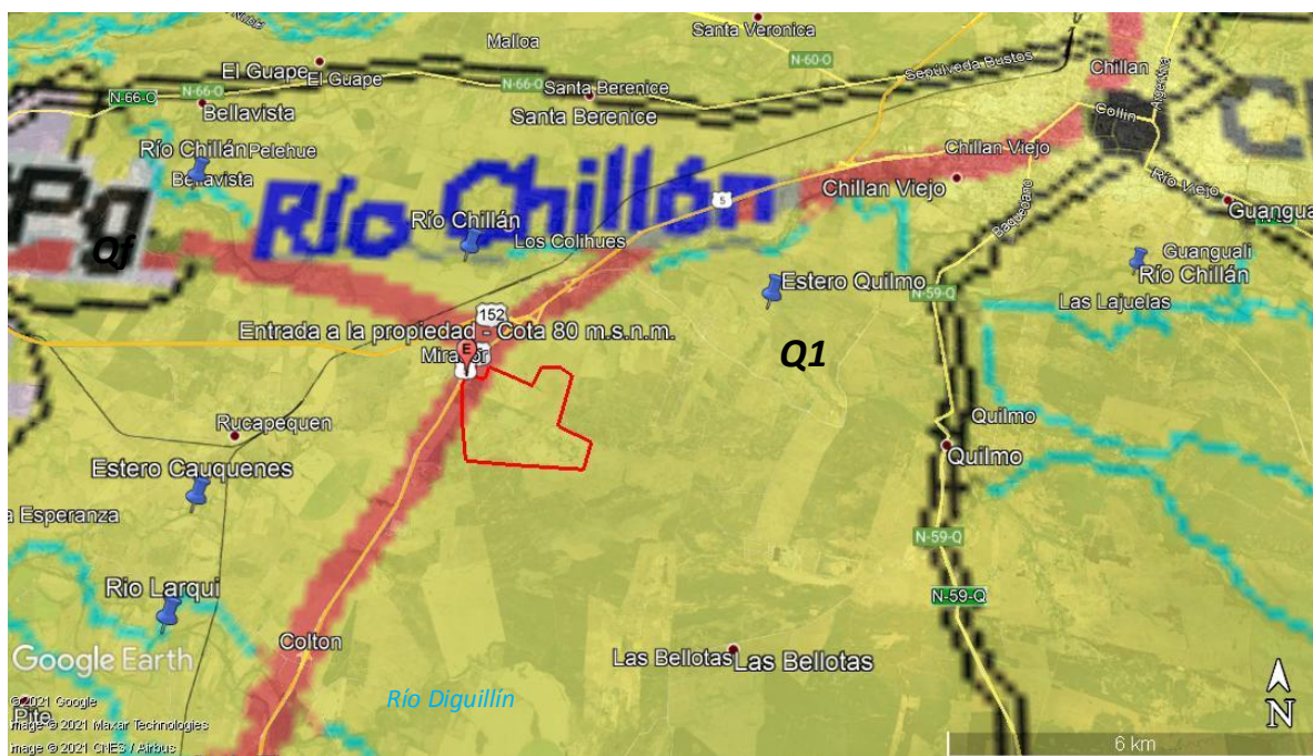
La parcela se emplaza como se aprecia con la marca de color amarilla, en la porción central del mapa (figura #5), sobre la franja sedimentaria de color amarilla, sobre el relleno aluvial del Río Diguillán , formación Cuaternaria de Edad Geológica Pleistocena – Holocena (Q1) ; estos están conformados mayormente por depósitos aluviales y coluviales en menor proporción, es posible también sedimentos del tipo remoción en masa, los que hace una especie de conos aluviales y deltaicos cercanos a los Ríos mayores, en nuestro caso estos formarían conos y meandros sedimentarios en las inmediaciones del Río Chillán .
