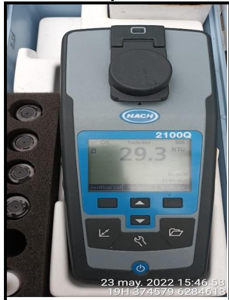
Fotografía N° 6 Medición de Turbiedad Punto 3: Compuerta 3
