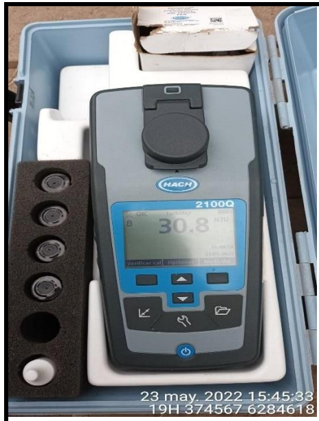
Fotografía N° 6 Medición de Turbiedad Punto 3: Compuerta 3
