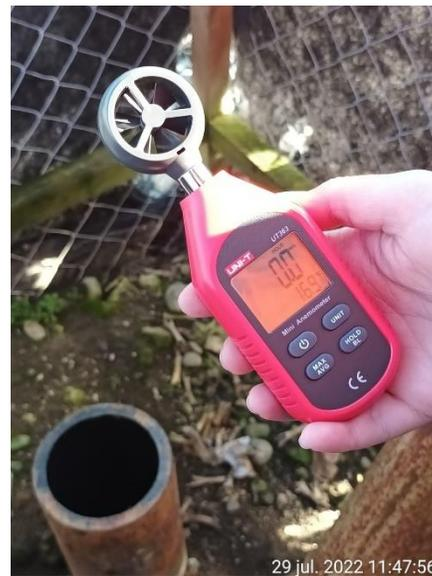
Como se aprecia en las fotografías, solo una de las chimeneas medidas registra generación de biogás con 0,4 m/s dando una emanación de 0.052 m<sup>3</sup>/s
