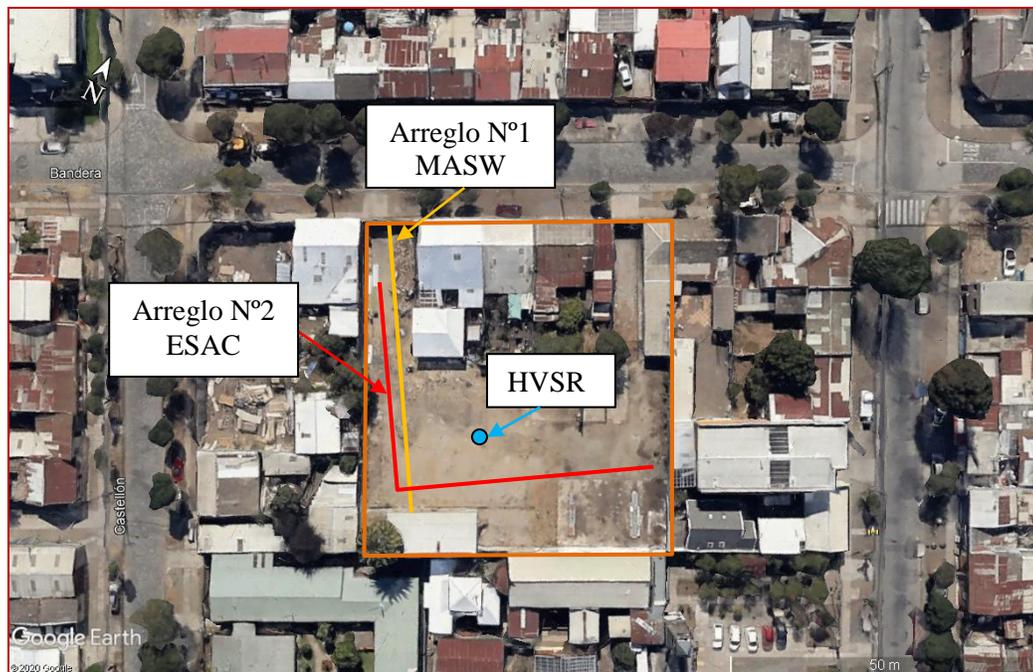
**Fig. N°2 : Ubicación de los Arreglos Geofísicos**
