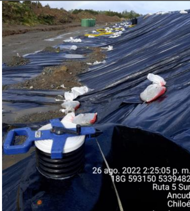
Fotografía N°43: Medición de Niveles de cámaras por Personal Municipal. Tomada: 26 de Agosto del 2022.
