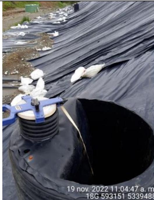
Fotografía N°40: Medición de Niveles de cámaras por Personal Municipal. Tomada: 19 de Noviembre del 2022.
