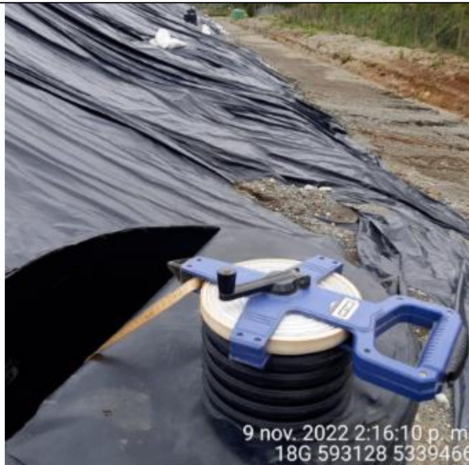
Fotografía N°32: Medición de Niveles de cámaras por Personal Municipal. Tomada: 09 de Noviembre del 2022.
