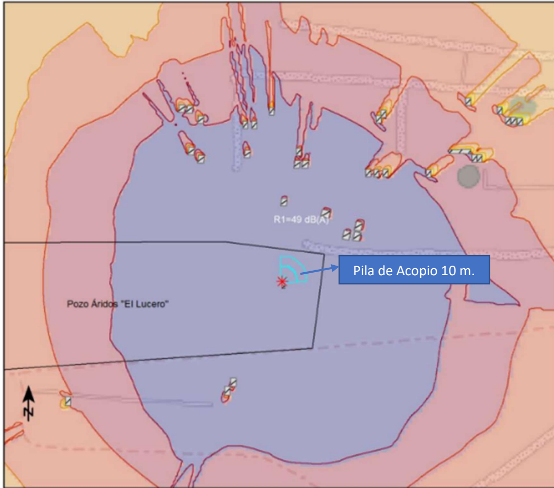
Figura 2.- Ubicación de la pantalla acústica de la Fuente 2 de la faena "Áridos Lucero"
