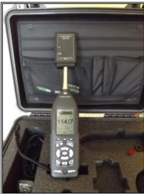
Figura 4. Sonómetro calibrado a 114 dB con frecuencia de referencia 1 kHz.
