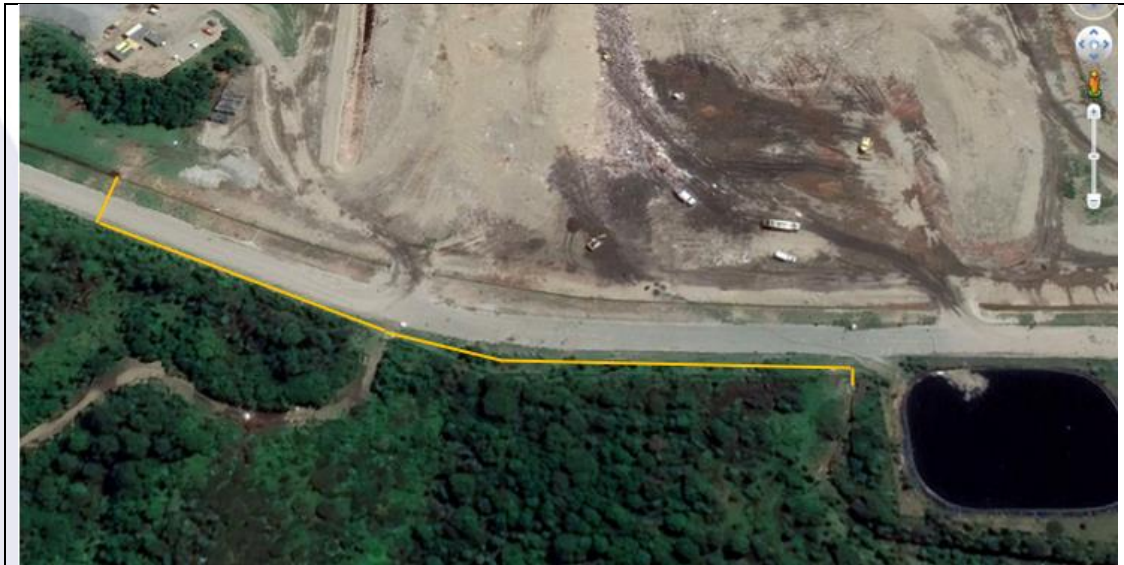
Trazado de descarga de aguas lluvias
