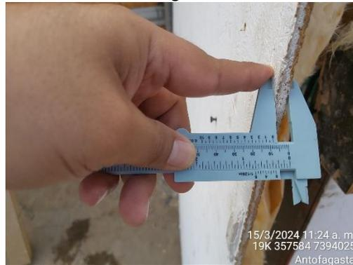
**Descripción medio de prueba:** Materialidad de cabina de generador eléctrico (OSB de 8 [mm]).
