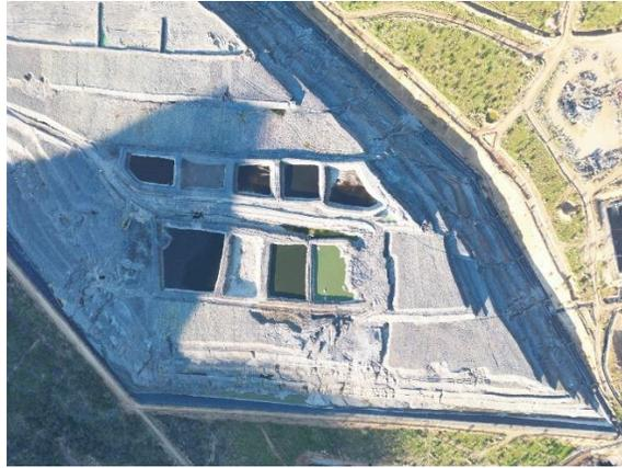
A continuación, se muestran imágenes georreferenciadas de la reparación terminada de los taludes del pozo N° 2, el cual presentó la falla operacional.
