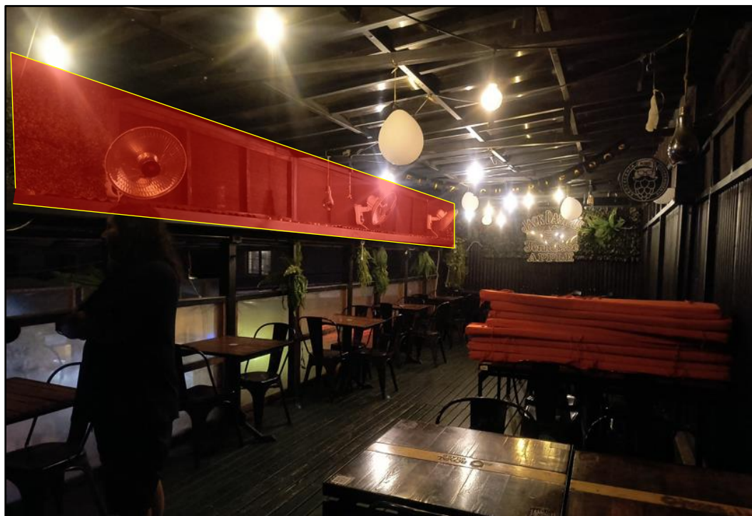
Figura 7. Ubicación transparencias acústica desde 2do piso (parrón de acero) del local hacia el exterior.
